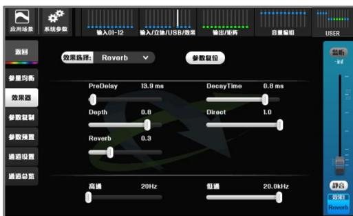
【PreDelay】：预延时。前反射声和直达声之间的时间间隔，PreDelay越大，空间越大。
