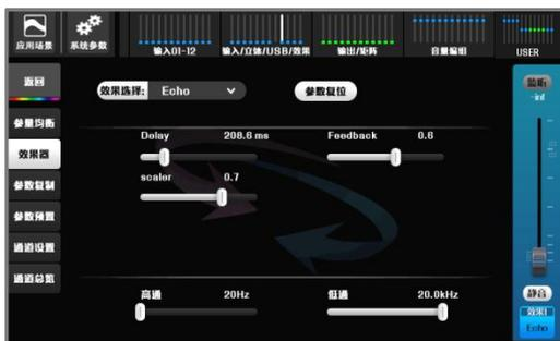
【Delay】：延时，单位ms。延时输入信号和反馈信号。
