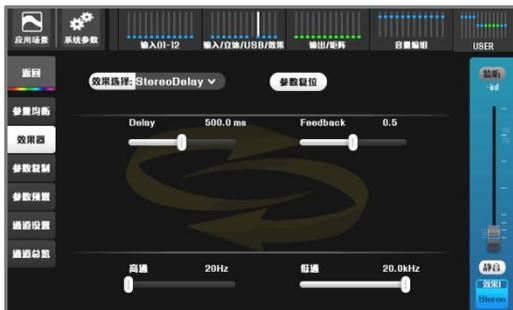
**【Delay】**：延时。营造一种左右声道声音来回移动的效果，越大，效果越明显。
