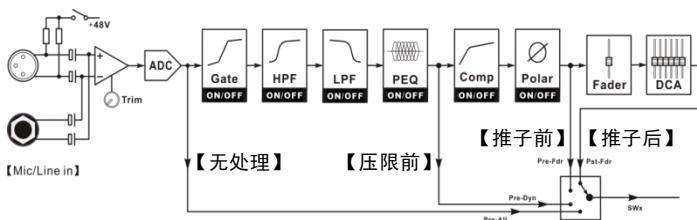
因应不同输出总线的需要，对输入信号源作出独立的选择，比如AUX1需保留输入通道CH01的原始信号，那么选择接入点为【无处理】（所有处理单元之前）即可。而AUX2则希望输入通道CH01经过EQ处理，但不要压限处理，那么接入点选择为【压限前】（压限器之前）。AUX3则希望经过压限器处理，但不能受输入通道音量的影响，那么接入点选择为【推子前】（推子之前）。AUX4则希望有所有的处理，并且受输入通道音量和DCA控制，则接入点选择为【推子后】（推子之后）。以上仅是例子，各输出总线对同一输入通道可单独选择不同的接入点。
