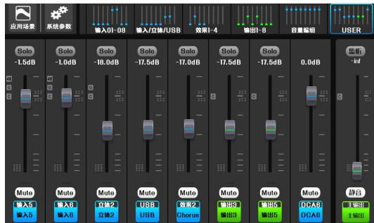
在系统设置界面 系统参数 单击按键【USER编辑】，或者在面板双击按键 进入自定义推子编辑模式。单击任何推子翻页按键即可退出自定义编辑界面。
