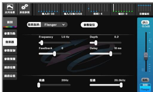
**【Frequency】：**调制频率。快的调制频率导致一个颤音效果，但太快又会导致移频。
