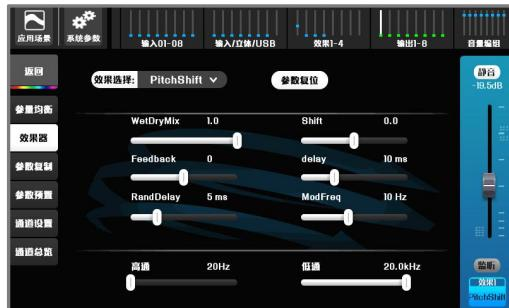
**【WetDryMix】**：干湿混合。输入信号和延时信号的混合。
