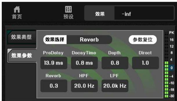
【PreDelay】：预延时。前反射声和直达声之间的时间间隔，PreDelay越大，空间越大。
