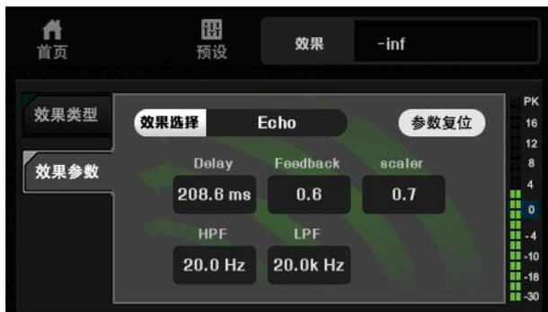
【Delay】：延时，单位ms。延时输入信号和反馈信号。
