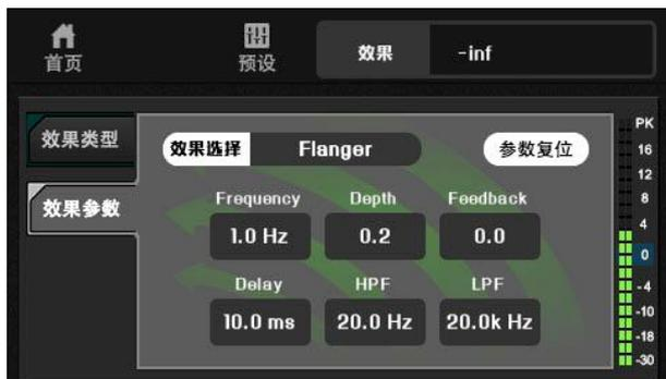
【Frequency】：调制频率。快的调制频率导致一个颤音效果，但太快又会导致移频。
